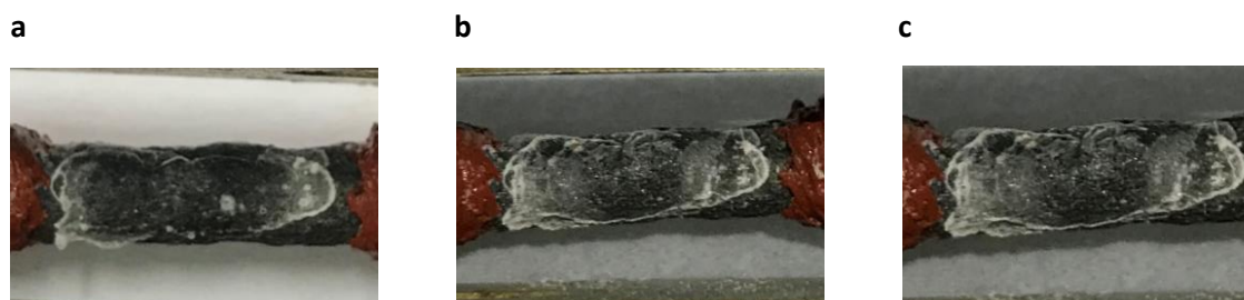
Figura D1. a) Capa de NaCl cristalizado extendida sobre la superficie del tubo de biocarbón luego de 10 min de operación. b) + 5 min. c) + 5 min.
