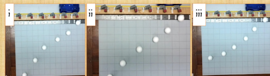
Figura 4. i) El móvil tiene una aceleración menor que la de las esferas. ii) Ambas aceleraciones son iguales. iii) El móvil tiene una aceleración mayor que la de las esferas
