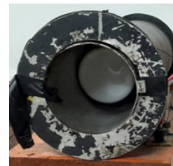
Figura 6a (arriba); Sistema experimental y Figura 6b (abajo); vista frontal del solenoide utilizado. En el interior del mismo se observa el CRT.
